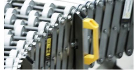
Correa de seguridad para movimiento de los transportadores flexibles.
